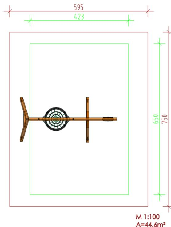
**Ausführung:** Gebirglärche Kantholz splintfrei, kernfrei, unimprägniert, mit feuerverzinkter Stahlaufständerung, Schaukelbalken Holz oder Stahl
