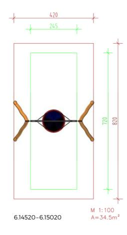
Fallraum bei bodenbündigen Übergang in die Umgebungsfläche.
